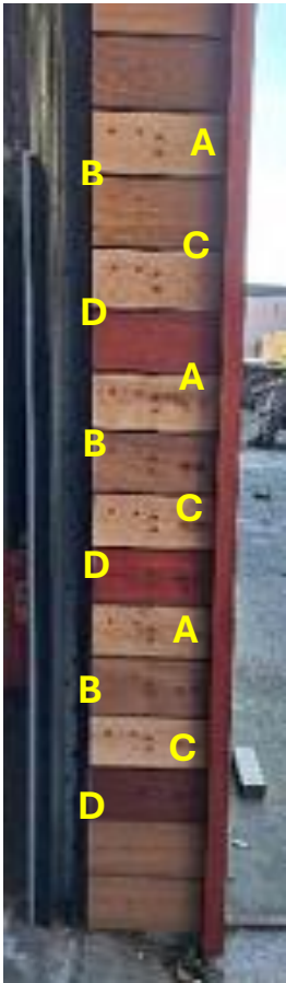
Foto 1: Monsters aan gevel. A = eiken (vers), B = iroko, C = Eiken (gedroogd), D = padoek (Hoekstra, 2025). Onderste monster zit op ongeveer 30 cm boven de grond.
