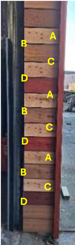
Foto 1: Monsters aan gevel. A = eiken (vers), B = iroko, C = Eiken (gedroogd), D = padoek (Hoekstra, 2025). Onderste monster zit op ongeveer 30 cm boven de grond.
